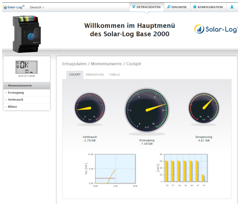
Abb.: Hauptmenü Solar-Log Base 2000
